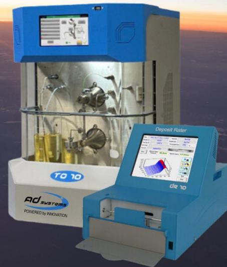
La prueba de estabilidad térmica (JFTOT) es una de las pruebas más importantes para la calidad del combustible de aviación (JET).
